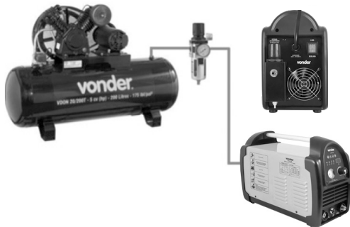
Fig. 1 – Suministro de aire comprimido
